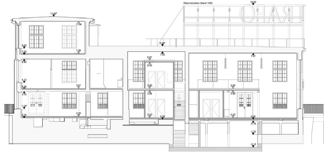
Longitudinal section Trafo building
